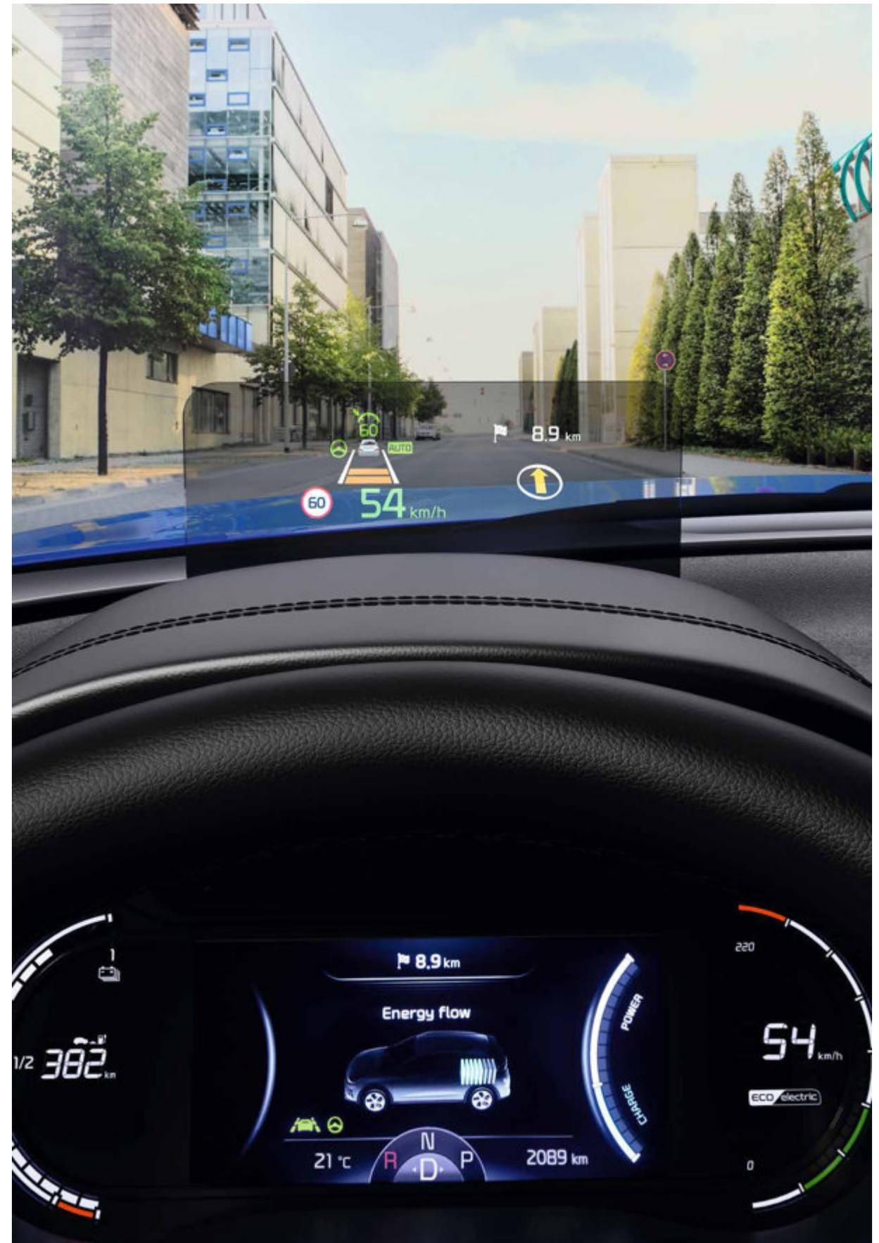
**Head-up-Display (HUD).** Das innovative Head-up-Display von Kia minimiert Ihre Ablenkung, indem wichtige Fahrdaten wie Geschwindigkeit, Sicherheitssymbole und Navigationsanweisungen direkt vor der Windschutzscheibe oberhalb der Instrumenteneinheit angezeigt werden. Ausserdem können Audioinformationen eingeblendet werden.
