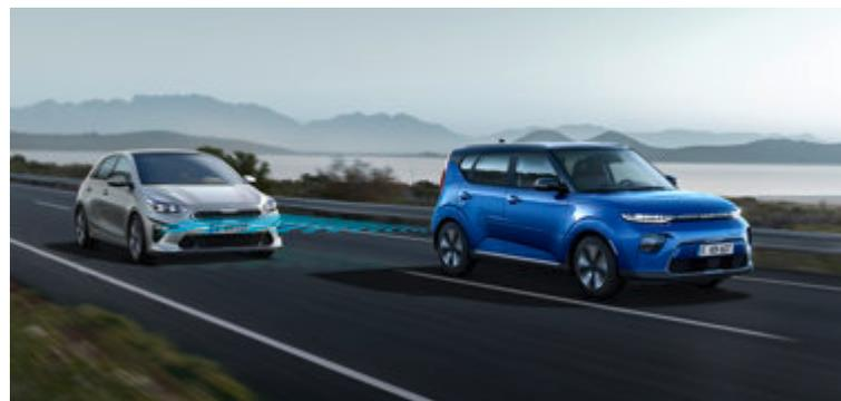
**Totwinkelwarner (BCW).** Der Totwinkelwarner überwacht mittels Radarsensoren Ihren toten Winkel und warnt Sie vorkommenden Fahrzeugen, indem im Seitenspiegel ein Symbol aufleuchtet.
