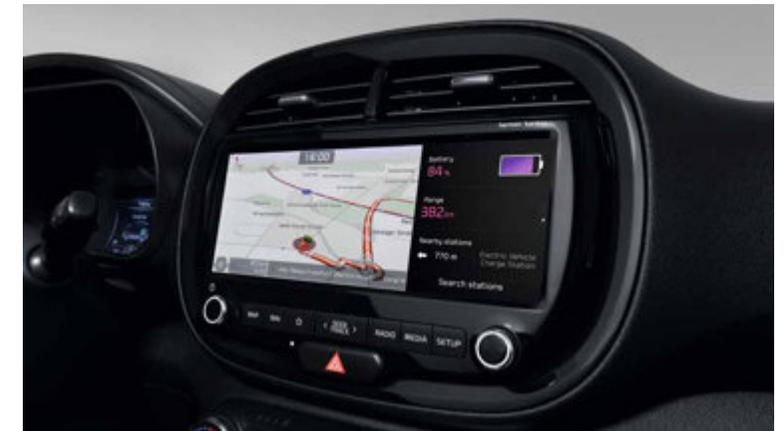
**Navigationssystem.** Das hochauflösende, 10,25" Navigationssystem bietet eine erweiterte Aufteilung des Bildschirms, die es Ihnen ermöglicht, Navigation, Wetter, Kompass sowie auch Informationen zum Ladezustand der Batterie, zur Reichweite und zur nächsten Ladestation gleichzeitig anzuzeigen. Darüber hinaus bietet der Bildschirm eine Bluetooth-Mehrfachverbindung, sodass zwei Geräte gleichzeitig angeschlossen werden können - für die konventionelle Verbindung sowie für die Audioübertragung.
