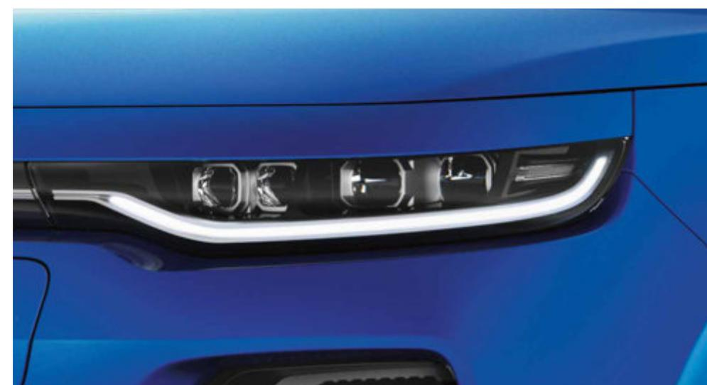
**LED-Scheinwerfer.** Die standardmäßigen LED-Scheinwerfer für Fern- und Abblendlicht mit LED-Tagfahrlicht sind nahtlos in die schlanke Front integriert.
