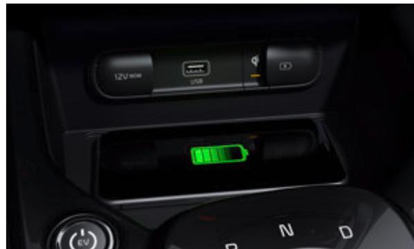
**Induktive Ladestation für Smartphones.** Laden Sie Ihr kompatibles Smartphone drahtlos und mühelos auf, indem Sie es auf die Ladestation in der Mittelkonsole legen. Das System warnt Sie sogar, wenn Sie beim Verlassen des Fahrzeugs Ihr Gerät vergessen.
