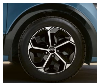
Jantes en aluminium 16". 6,5J x 16, adaptées pour des pneus 205/60R16. Chapeau de moyeu et 5 écrous de roue inclus. 14/ATF40AK000 (bicolore, HEV/PHEV)
