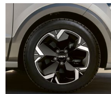
Jantes en aluminium 17". 7,0J x 17, adaptées pour des pneus 215/55R17. Chapeau de moyeu et 5 écrous de roue inclus. 14/ATF40AK020 (bicolore, EV)
