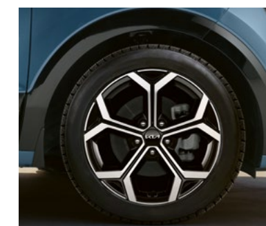
Jantes en aluminium 18". 7,5J x 18, adaptées pour des pneus 225/45R18. Chapeau de moyeu et 5 écrous de roue inclus. 14/ATF40AK010 (bicolore, HEV/PHEV)
